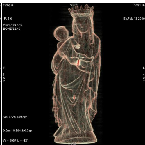
Obrázek 27 Socha Madony: virtuální průhledný model; Počítač má přednastavených několik presetů pro zvýraznění některých materiálů, v tomto případě kovu.
