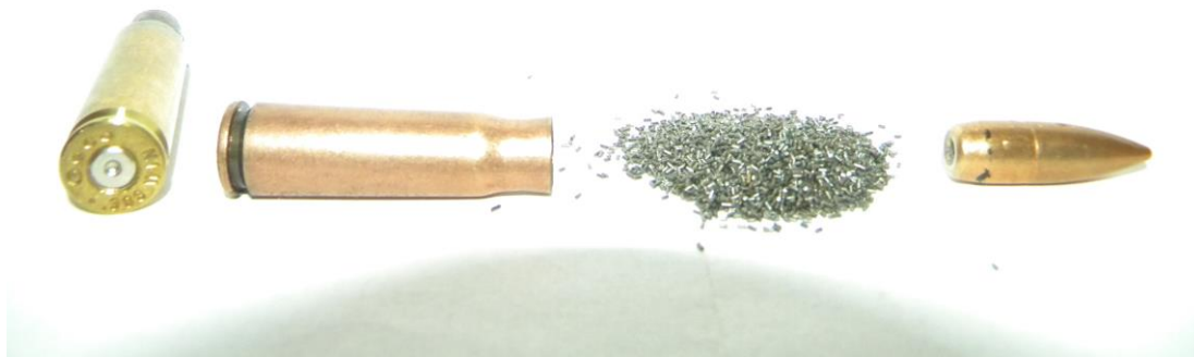
Obr.č 1. Kulový náboj - zápalka, nábojnice, výmetná náplň a kulka.
