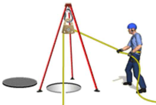
Obr. 18 – Užití kotevní trojnožky jakožto zvýšené fixní či deviační body pro vedení lana (www.vrigger.com)
