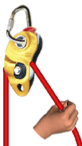
Obr. 20 - Užití kladky s jednosměrným mechanickým blokováním lana sloužícímu k vytahování pacienta (www.vrigger.com)
