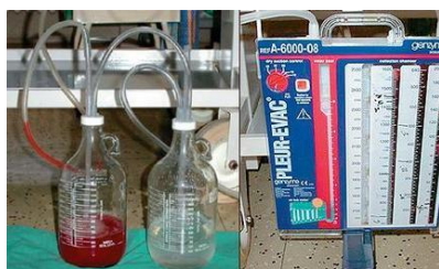
Obr. 1 – Resterilizovatelný systém skleněných lahví – dvoulahvový systém
