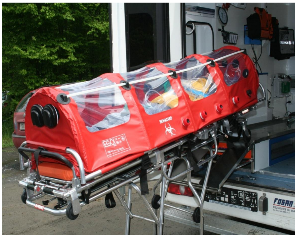
obr. 2 – Biovak s vlastní filtroventilační jednotkou
