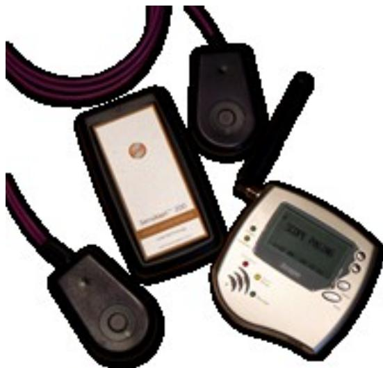
**SENSALERT** – senzor pohybů, umisťuje se pod matrací
