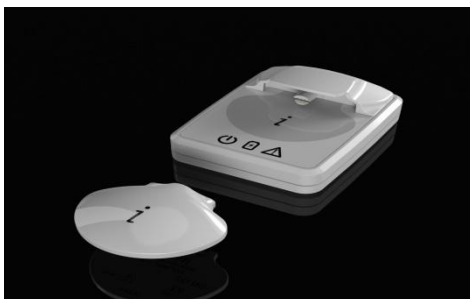
Obr. 3: senzor s adaptérem pro přenos dat
