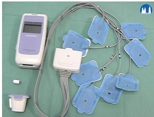
Obrázek 1 – Endoskopická kapsle se snímacími anténami a záznamové zařízení
