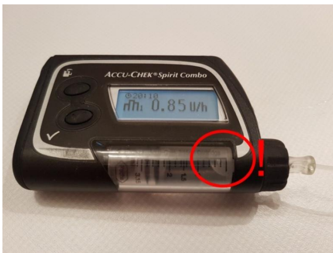
Ukázka přítomnosti vzduchové bubliny v zásobníku inzulínové pumpy
