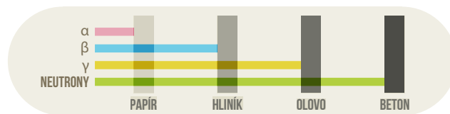
Průnik záření různými druhy materiálů
