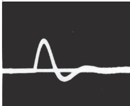
Obrázek 1. Oscilogram prahového defibrilačního impulsu – kondenzátorový impuls vedený přes indukci
